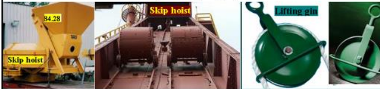
بالابر پایه دار (Lifting gin) * چرخ کشنده محفوظه - skip hoist
