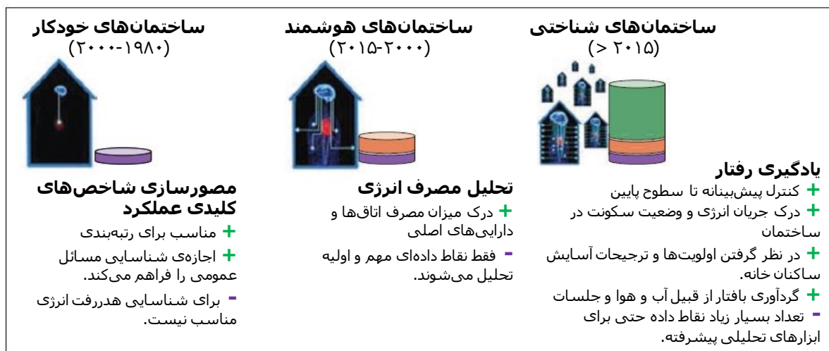
شکل ۱۳.۵ چارچوب بلوغ ساختمان شناختی آی‌بی‌ام
