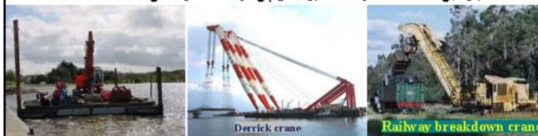
جرثقیل : کار در خط آهن فرسوده - دکل دار - شناور (شماره ۸۴۲۶)
