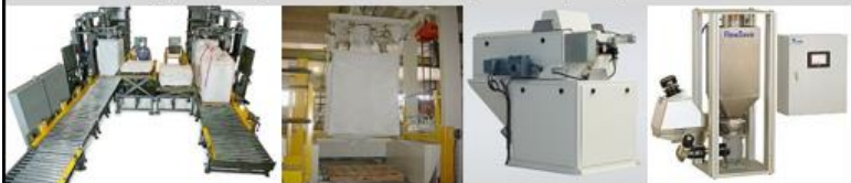
توزین گر کبسه گیری گرد فلز ، ترازوی بسته های پیاده شده از کانتینر
