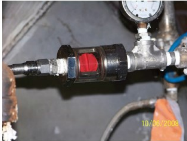
شکل ۱۶-۳- نشانگرهای بصری جریان پمپ خمیر کاغذ (به لطف کنت لاتینو)
