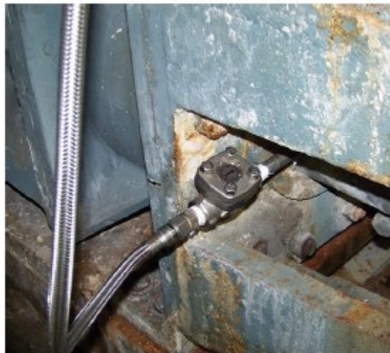
شکل ۱۶-۴- بهبود شیرهای یک طرفه پمپ خمیر کاغذ (به لطف کنت لاتینو)
