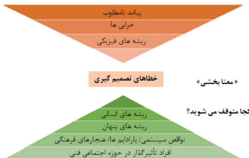
شکل ۱۴-۲- بازسازی یک رویداد هنگام به کار بردن رویکرد مؤثر RCA
