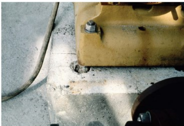
شکل ۱۲-۳- شل شدن پیچ های مهارى روى پاىه تجهيز (به لطف تيم قابليت اطمینان)
